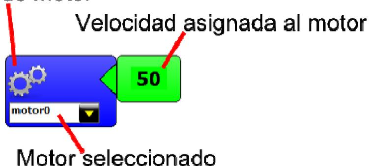
Como queremos que el robot avance durante un tiempo determinado y luego frene, asignamos velocidad 50 al motor 1 y luego le asignamos tiempo. Para determinar la duración del avance seleccionamos el bloque que contiene un reloj al que le asignamos el tiempo correspondiente. En nuestro ejemplo escribimos el número "5000" porque queremos que avance durante 5 segundos. El tiempo está expresado en milisegundos.
