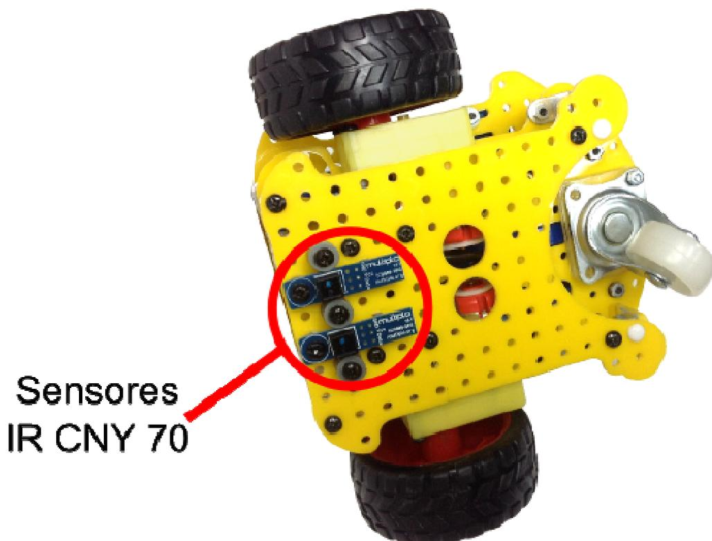
2- Cableado: A uno de los sensores IR lo cablearemos como en la actividad 3.1: "Testeo de un sensor IR". Al otro, lo cablearemos en los pines que están al lado de estos, tal como se muestra en la siguiente tabla.
