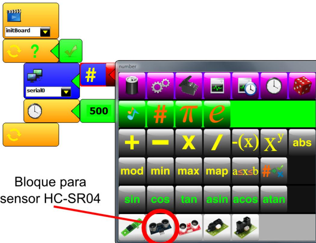
Una vez seleccionado el bloque específico para sensor HC-SR04, seleccionamos el pin al que lo conectamos. Si nos fijamos en la imagen de miniBloq que muestra la numeración de los pines, notaremos que, junto a "sensor1" dice "D15" sobre fondo verde y, a su izquierda, "Trig" sobre fondo anaranjado.
